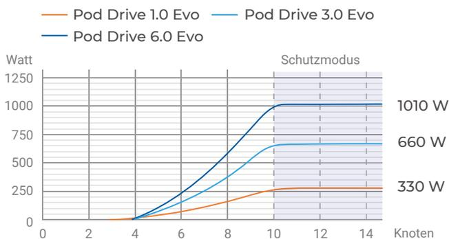
\* Der Pod Drive Evo 6.0 wurde mit dem dreiflügeligen Aluminiumpropeller 12,6" x 8,7" getestet.
